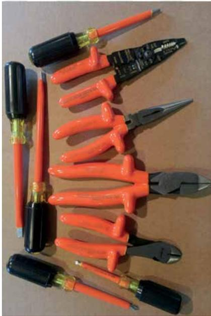
Cada herramienta OEL fabricada para la exposición hasta 1000VAC y dieléctricamente probado a 10.000 VAC.
