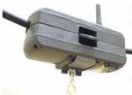
Dispositivo para medición, monitoreo de calidad de la energía según (IEC 61000-4-30 Clase A Ed 2.0) y análisis con capacidades de registro digital de fallas (512 muestras por ciclo) y fenómenos transitorios ultra rápidos.
