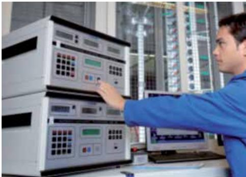
Los equipos de Tettex Instruments ofrecen todo lo necesario para lograr las pruebas tipo o de rutina de los transformadores de instrumentación convencionales y no convencionales. El diseño preciso de todos los componentes permite pruebas altamente precisas de relación y ángulo de fase acorde a la IEC, ANSI y otros estándares internacionales.
